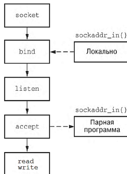
Рис. 2. Схема системных вызовов в последовательном сервере
