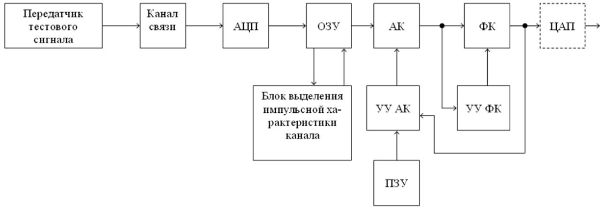
Рис. 1. Схема коррекции характеристик канала
